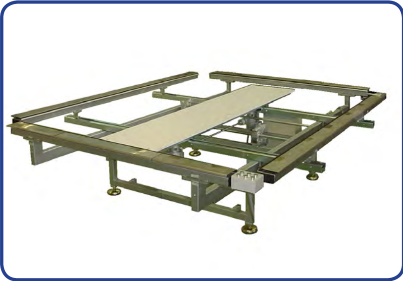
Tensador motorizado. Estira la tela en sentido longitudinal, transversal. Elevación de los marcos para mejorar la aplicación de la tela al marco. Sistema de coger la tela por placas articuladas.
