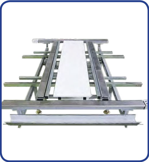
Tensador motorizado. Estira la tela en sentido longitudinal, transversal. Elevación de los marcos para mejorar la aplicación de la tela al marco. Sistema de coger la tela por placas articuladas.
