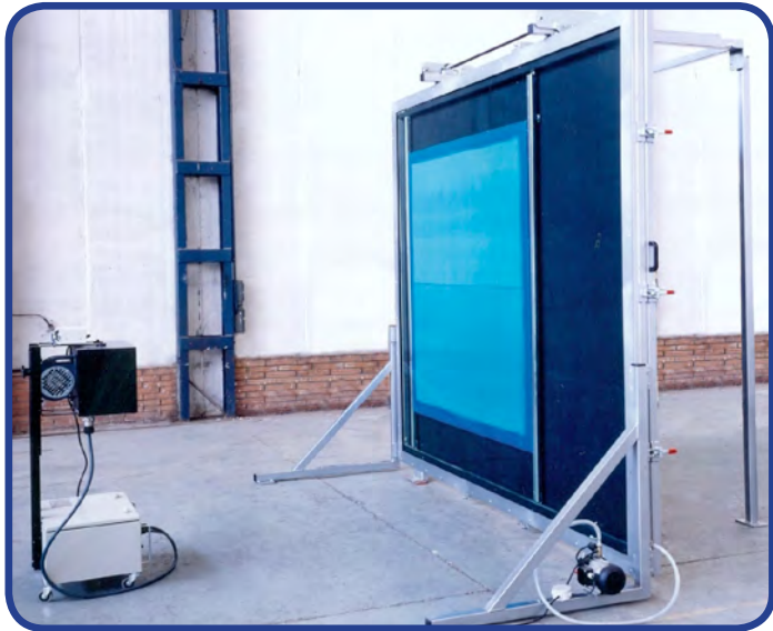
El vidrio es fijo, la mantilla se desplaza por guías laterales. Está provisto de pivotes interiores para alojar la pantalla que sirve de registro para situar todas las pantallas en el mismo lugar.
